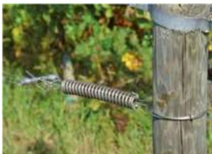
Ressort amortisseur pour la tension des fils mobiles. Système particulièrement robuste pour piquets de tête en bois de 10 cm de diamètre. Le ressort permet l'allongement des fils pour pouvoir les positionner à différentes hauteurs lors du relevage.
